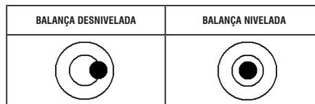
Quando a balança está nivelada, a bolha de ar fica centralizada dentro da circunferência. Para centralizá-la, certifique-se de que a instalação seja em uma superfície plana e livre de vibrações.
