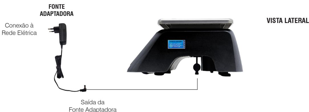
Após verificar a tensão desejada, conecte a fonte adaptadora no conector de entrada da sua Prix Splash bp201w, localizado na parte inferior da base da balança, conforme exibido na figura acima.
