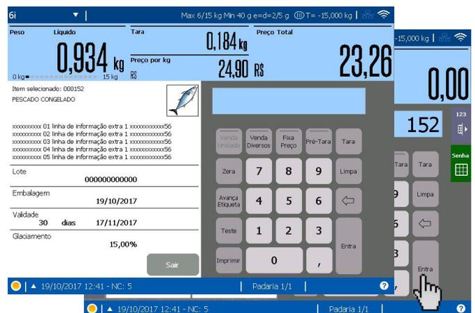
Automaticamente a balança irá calcular o valor do peso a ser descontado, correspondente ao percentual de congelamento do produto "Pescado Congelado" e subtrairá do peso bruto (peso líquido+água), indicando momentaneamente o resultado (peso líquido) no display. Uma etiqueta será impressa com as informações de Tara (recipiente+teor de água), recipiente, teor de água, peso líquido, preço/kg e valor total.
