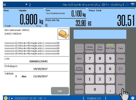
Após a impressão da etiqueta, retire o produto do prato de pesagem. Automaticamente os displays serão limpos e o indicador "Líquido" se apagará, continuando aceso o indicador de "Pré-Tara". Para sair do modo de operação com Tara Predeterminada, tecle "Pré-Tara", o indicador de acionamento se apagará.
