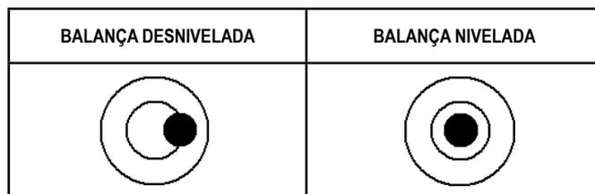
Quando a balança está nivelada, a bolha de ar fica centralizada dentro da circunferência. Para centralizá-la, regule os pés da balança, caso haja necessidade de efetuar o nivelamento.
