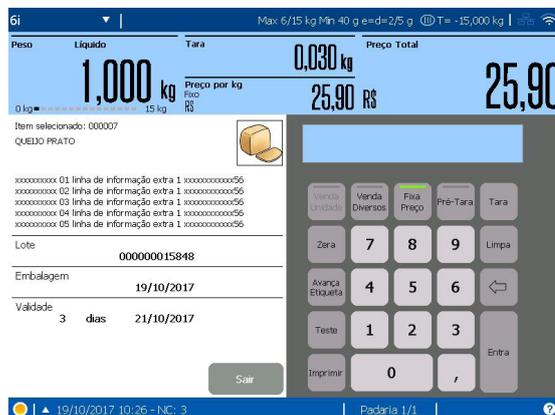
Após a exibição do preço total, será emitida uma etiqueta com os dados da pesagem. A impressão automática ocorre para pesos superiores a 40 g (20e e=menor divisão da balança). Se o parâmetro de programação "Impressão auto. no modo fixa preço" estiver desligado.
