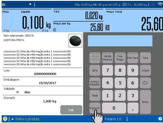
Com o líquido (salmoura) adicionado pressione "Imprimir". Uma etiqueta será impressa com as informações de Tara, Peso Líquido, Peso Drenado, preço/kg e Total. O valor do líquido (salmoura) e o valor de peso drenado serão somados e impressos na etiqueta como Peso Líquido. O valor do recipiente ou embalagem e o valor do líquido (salmoura) serão somados e impressos na etiqueta como Tara.
