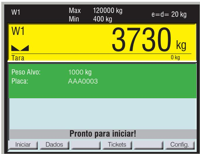
Após o início do processo de enchimento, um sinal elétrico de saída (OUT0) estará disponível ao usuário/cliente, que poderá ser utilizado para acionar qualquer dispositivo que auxilie na alimentação do material desejado.
