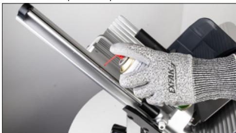
Utilizando um spray ou um pincel com o lubrificante, lubrifique a guia deslizante do apoio do produto.
