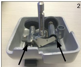
Limpe o excesso de óleo, encaixe o conjunto do afiador da lâmina e reaperte o manípulo do afiador da lâmina (3).
