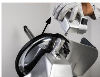
Utilizando um spray ou um pincel com o lubrificante, lubrifique os rolamentos do afiador da lâmina, nos pontos indicados abaixo (2).
