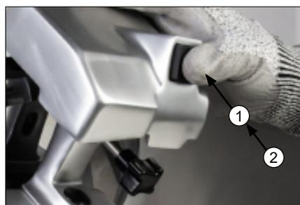
Após completar a afiação, aconselhamos a limpeza da lâmina usando uma esponja não abrasiva com sabão neutro. Em seguida retorne o afiador para a posição original.
