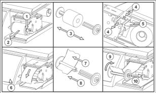
Passo 1: Abaixe a alavanca de trava do rebobinador e puxe a impressora para frente até que ela saia do interior do gabinete da 6i. A impressora desliza sobre um guia no chassi da balança, permitindo movimentação para dentro e fora do gabinete da balança. Durante o uso a impressora deverá estar posicionada dentro da 6i. A mobilidade da impressora é travada pelo encaixe da trava esquerda do liner no orifício existente no chassi da 6i (lado esquerdo da
