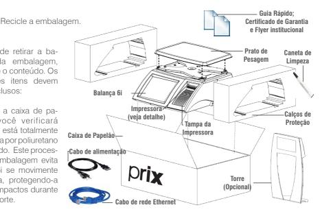
Após retirar a 6i da caixa de papelão, remova a tampa da impressora e retire o calço de papelão do mecanismo da impressora.
