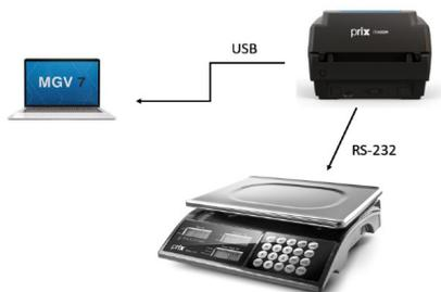
A Impressora Térmica com Memória PRIX IT400M está apta para comunicar com o MGV 7 e as balanças da linha comercial, como por exemplo: 3 Fit e 3 Plus.
