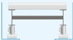
Balança eletrônica com Células de Carga Digitais PDX.
