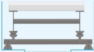
Balança mecânica ou eletromecânica com alavancas, cutelos e coxins.
