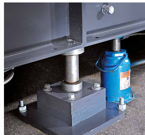
Detalhe do pino de apoio para montagem da estrutura metálica da balança.
