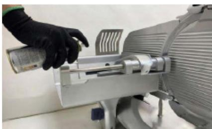
Utilizando um spray ou um pincel com o lubrificante em sachê, lubrifique a guia deslizante do apoio do produto.
