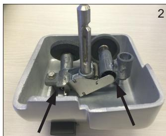
Limpe o excesso de óleo e encaixe o conjunto do afiador da lâmina (3).
