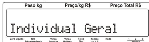
Utilize uma das três teclas , ou para selecionar a opção "Geral" e em seguida tecele com "Geral" piscando. Será exibida a mensagem abaixo:
