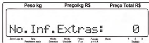
Tecla **Entra** e será exibida a quantidade de fornecedores cadastrados na balança (quando gerenciada pelo MGV 7) conforme tela a seguir:
