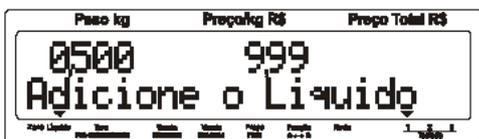
Com o líquido (salmoura) adicionado, tecla . A balança voltará a exibir momentaneamente no display o peso drenado das azeitonas, o preço/kg e o preço total calculado com base no peso drenado.
