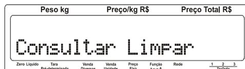
Utilize uma das três teclas , ou para selecionar a opção "Limpar" e em seguida tecele com "Limpar" piscando.
