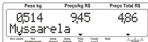
Após a exibição do preço total, será emitida uma etiqueta com os dados da pesagem. A impressão automática ocorre para pesos superiores a 40 g (20e = menor divisão da balança). Se o parâmetro de programação C03 estiver desligado, não haverá impressão automática. Veja página 45.
