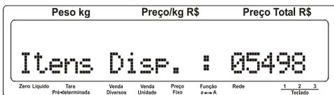
Tecl e será exibido o número da carga local da balança conforme tela a seguir:
