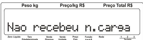
A primeira mensagem indica o número de carga local que a balança possui. O contador só funcionará quando a balança estiver operando em rede com o MGV 7.
