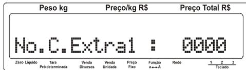
Tecl e será exibida a quantidade de campos extra 2 cadastrados na balança (quando gerenciada pelo MG 7) conforme tela a seguir:
