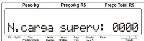
Tecl e será exibida a quantidade de receitas cadastradas na balança conforme tela a seguir:
