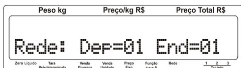
Para sair desta condição, o Modo Programação deverá ser acessado e o parâmetro C07 configurado para permitir o acesso à operação.
