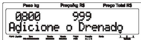
Com o display indicando o peso drenado, tecla **Pré-Tara**. O display de peso será zerado e exibirá a mensagem "Adicione o Líquido".
