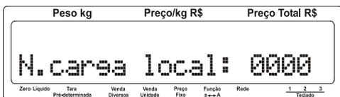
Tecl e será exibido o número da carga de supervisão da balança (quando gerenciada pelo MG 7) conforme tela a seguir:
