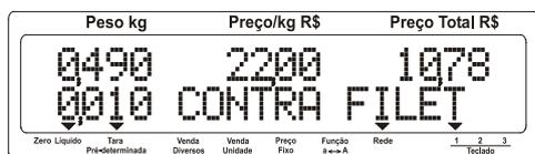
Em seguida, automaticamente será impressa a etiqueta com os dados da transação. Na etiqueta impressa, a tara predeterminada será indicada com as letras "TP" após o seu valor.
