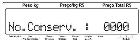
Tecl e será exibida a quantidade de fracionadores cadastrados na balança (quando gerenciada pelo MG 7) conforme tela a seguir:
