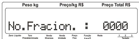
Tecl e será exibida a quantidade de campos extra 1 cadastrados na balança (quando gerenciada pelo MG 7) conforme tela a seguir:
