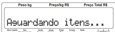
Na sequência, o MGV 7 atualizará automaticamente o cadastro de itens da balança e, durante o processo de atualização automática do cadastro de itens, será exibida a mensagem a seguir:
