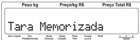
Após exibição momentânea da mensagem acima, em seguida será exibida a mensagem com o dígito da direita piscando, para edição da próxima Tara Predeterminada que se deseja cadastrar:
