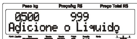
Com o líquido (salmoura) adicionado, tecla **Tara**. A balança voltará a exibir momentaneamente no display o peso drenado das azeitonas, o preço/kg e o preço total calculado com base no peso drenado.
