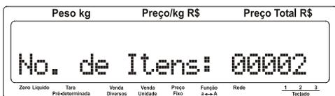
Tecl e será exibida a quantidade de itens restantes na balança conforme tela a seguir:
