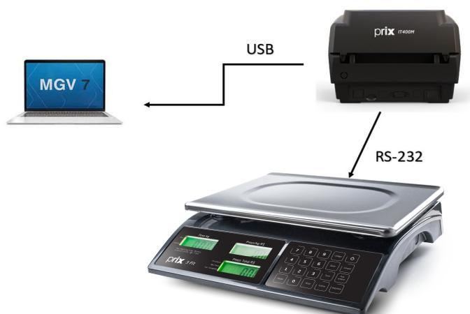
A Impressora Térmica com Memória Prix IT400M está apta para comunicar com o MGV 7 e as balanças da linha comercial: 3 Fit, 3 Plus e 9094.
