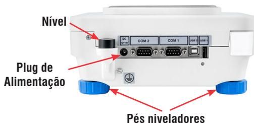
Após ajuste do nível, conecte o plug da fonte de alimentação na parte traseira da balança.
