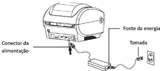
**Nota:** Desligue o interruptor de alimentação da impressora antes de conectar o cabo de alimentação no conector de alimentação da impressora.
