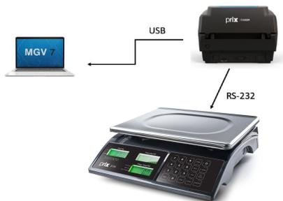
A Impressora Térmica com Memória PRIX IT400M está apta para comunicar com o MGV 7 e as balanças da linha comercial, como ,por exemplo: 3 Fit, 3 Plus e 9094.
