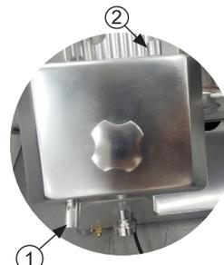
Após completar a afiação, aconselhamos a limpeza da lâmina usando uma escova pequena com sabão neutro. Em seguida retorne o afiador para a posição original.
