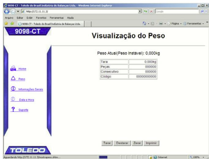
Esta tela permite que seja visualizado o peso atual da carga existente na plataforma da balança, eventual valor de tara, o número da pesagem (consecutivo), número do operador e código. Será possível também comandar do PC parte da operação da balança através dos botões localizados na parte superior da tela (TARAR, DESTARAR, ZERAR e IMPRIMIR), sendo que estas funções estarão vinculadas ao que estiver programado no terminal. Exemplo:
