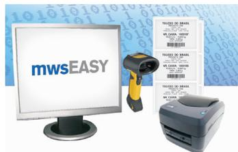
O 9098 CT pode operar em conjunto com o MWS (Move Weigh System). A comunicação é feita entre o terminal e o Servidor de Aplicativos MWS, através de uma rede Ethernet ou WLAN, utilizando-se do protocolo TCP/IP. Neste modo de operação, disponibiliza as
