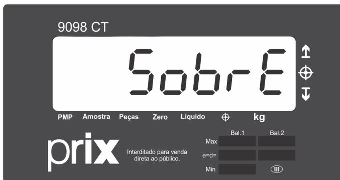
O 9098CT tem a função de controle de sobrecargas. Isto é muito útil para evitar danos em sua balança.
