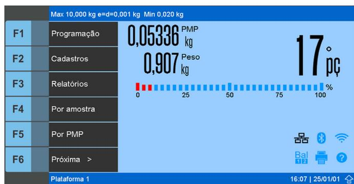
Ao serem colocadas mais peças sobre a plataforma, o TI 500 recalculará automaticamente o valor do PMP até o término da operação.
