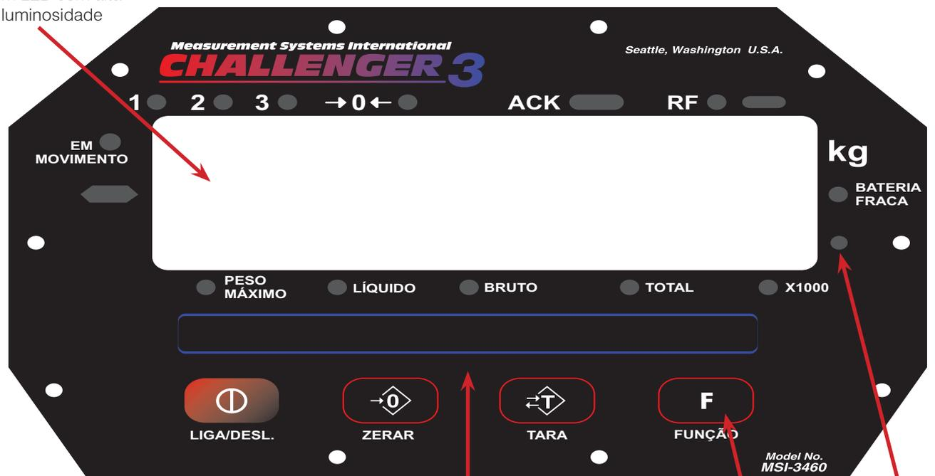
Sensor de luz para controle automático de luminosidade
