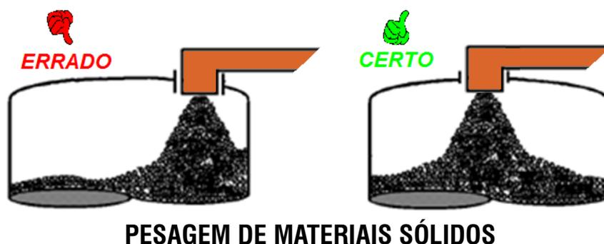
Sempre que uma tubulação for projetada para realizar a pesagem, de materiais líquidos, deve-se evitar que os materiais exerçam pressão contra as paredes laterais devido a turbulência, e nunca conecte tubulações diretamente no tanque. Procure introduzir a tubulação com folga. Utilizar tubulações flexíveis em caso de sistemas selados.
