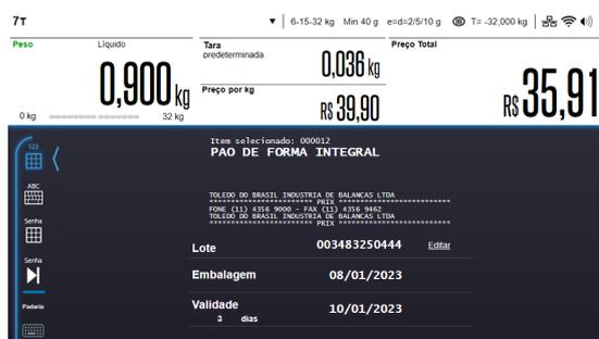
Após a exibição do preço total, será emitida uma etiqueta com os dados da pesagem. A impressão automática ocorre para pesos superiores a 40 g (20e e=menor divisão da balança).
